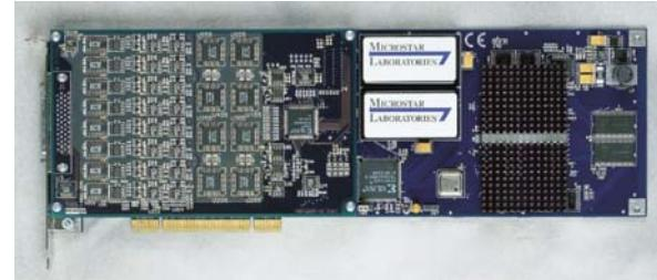
Microstar Laboratories, Inc., è un produttore di schede di acquisizione ed elaborazione dati serie DAP (Data Acquisition Processor) con CPU e sistema operativo multitasking Real-Time DAPL 2000 a bordo.
